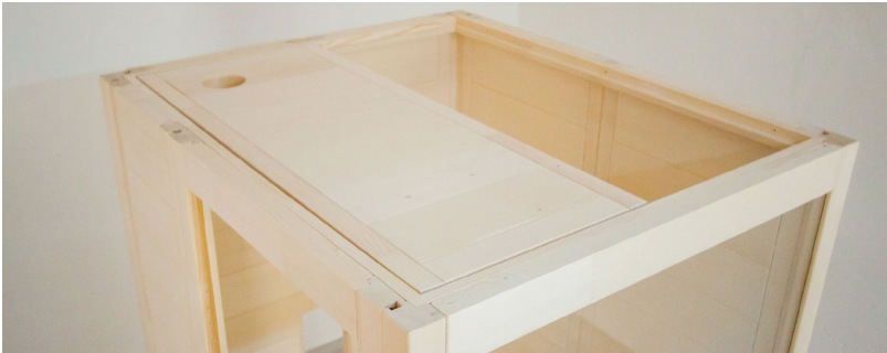
Abb. 14: Einlegen Dachelemente vorne
