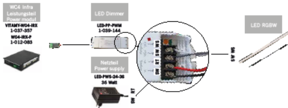
Fig. 27 : Raccordement de la RGBW LED à la commande
